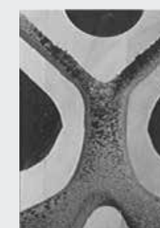
uszkodzenia kawitacyjne* powstałe w wyniku używania płynów do chłodziw niskiej jakości
