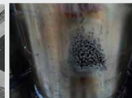
uszkodzenia kawitacyjne* powstałe w wyniku używania płynów do chłodziw niskiej jakości
