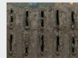
skorodowana chłodziwa po stosowaniu płynu niskiej jakości
